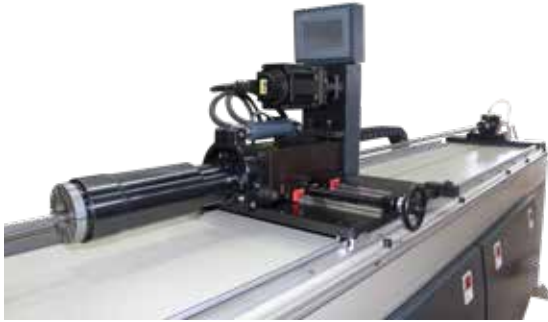
Servo Motorlu Döndürme Eksen Servo Motorised Rotation Axis
