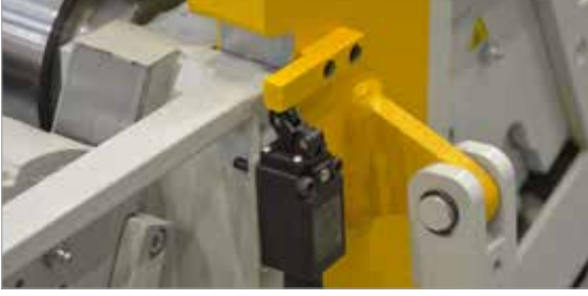
Standart Açılır Kafa Emniyet Svici Standard Safety switch on drop-end
