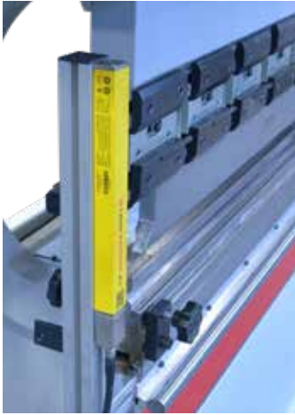
Standart: LEUZE IŞIK Bariyeri Sayesinde Öğretilebilir ve Programlanan Ön Bölge Güvenliği Standard: LEUZE LIGHTGUARD With Work Area Learning Feature
