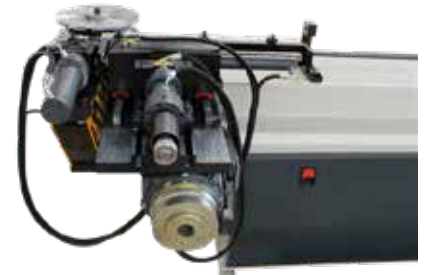
76NC ve 90NC lerde Direkt Tahrikli Redüktör Sistemi Direct Drive Reducer System for 76NC and 90NC
