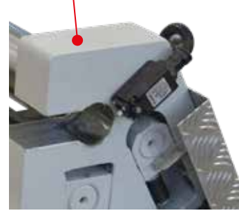
Standart kafa açma sviçi Standard drop-end safety switch
