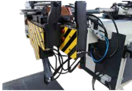
Büküm Kafası Arkasında Güvenlik Sacı Safety Plate on Back Of Bending Head
