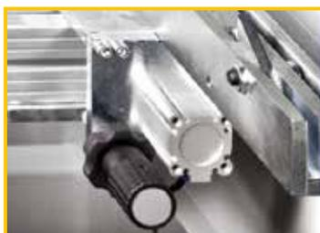
Système pneumatique de réglage de conicité par molette : +/- 3 mm
