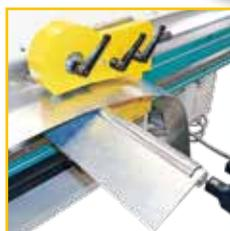
**2** Système pneumatique pour la conicité de la butée arrière
