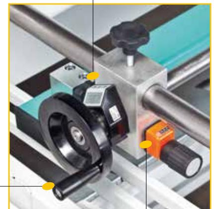
Réglage de la butée arrière par volant
